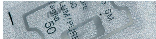
Ogni capo etichettato con RFID in standard EPC viene abbinato ad un serial number che lo rende elemento univoco a livello internazionale e sul web. Il vantaggio è la condivisione delle informazioni on line.
